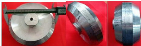
Hình 4.5 Khuôn hướng kính thực tế sau khi chế tạo
