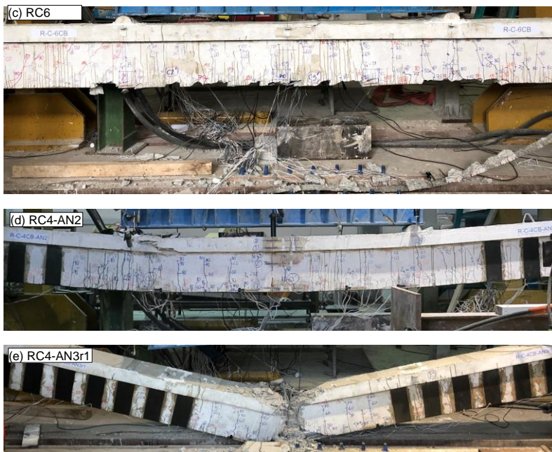
Hình 3.5 (tiếp theo). Kiểu phá hoại của các dầm nhóm RC
