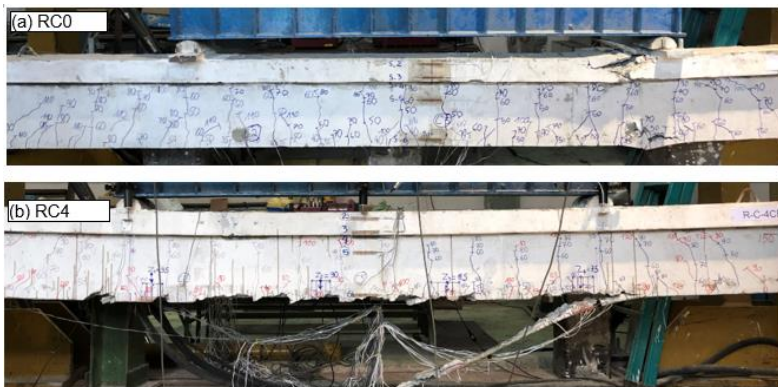
Hình 3.5. Kiểu phá hoại của dầm nhóm RC
