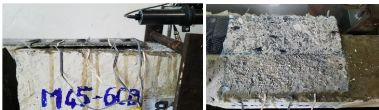
Hình 3.1. Kiểu phá hoại điển hình của mẫu kéo trượt đơn
