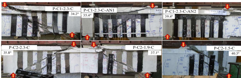
Hình 2.13 Kiểu phá hoại của dầm cáp thẳng gia cường CFRP/GFRP nhóm C
