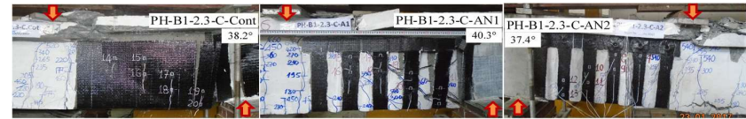
Hình 2.14 Kiểu phá hoại dầm cáp cong gia cường tấm CFRP/GFRP nhóm B
