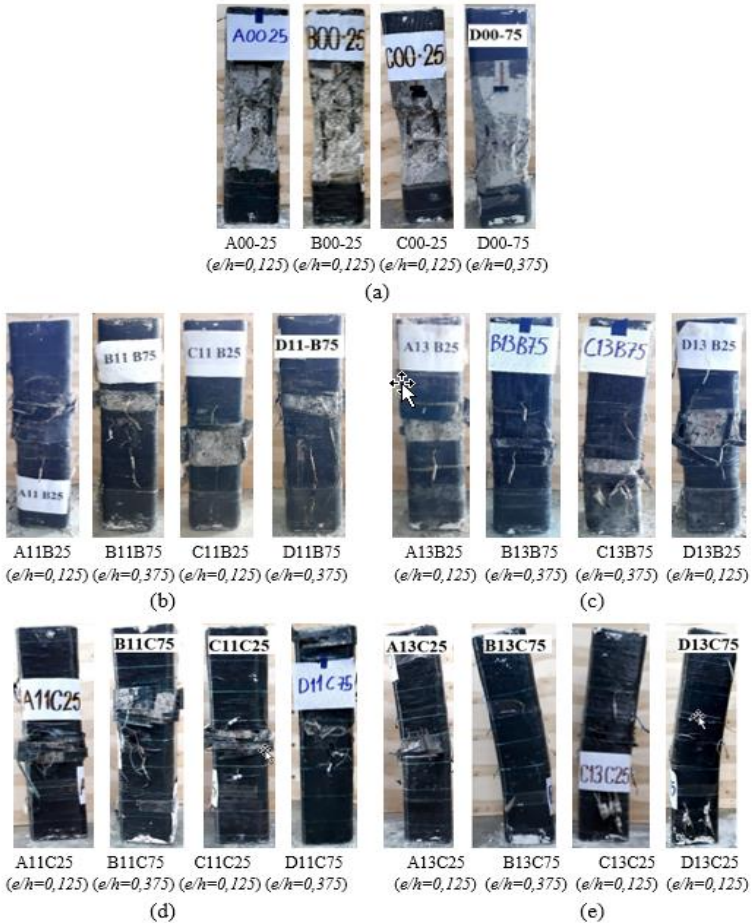
Hình 3.4: Kiểu phá hoại của cột bị ăn mòn cốt thép
