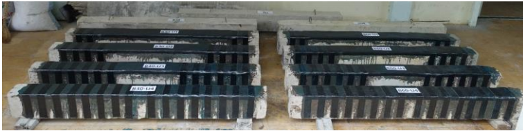
(g) Các dầm bị cháy sau khi gia cường CFRP có sử dụng U-wrap
