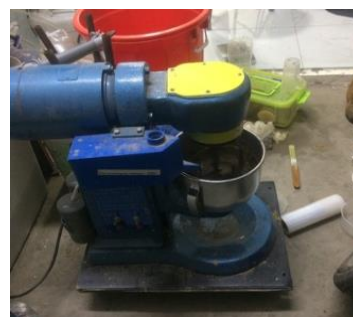
c) Trộn hỗn hợp bằng máy trộn
