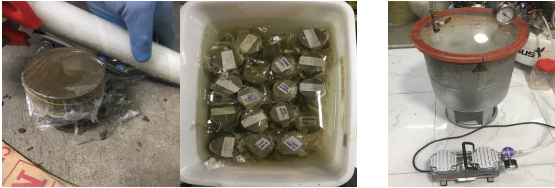
g) Ngâm bảo dưỡng mẫu trong nước k) Bảo hòa mẫu bằng hút chân không
