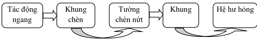
Hình 2.23. Sơ đồ chịu tải của khung có tường xây chèn thông thường.
