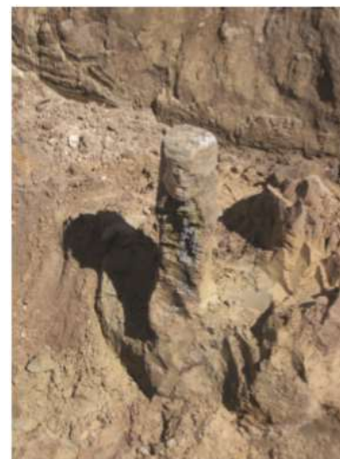
Hình 1.1: Cột geopolimer được tạo bằng cách khoan phụt vữa geopolimer trong đất [11]
