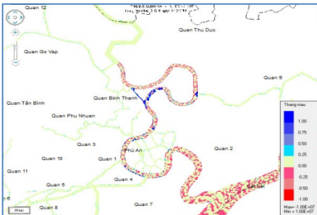
Hình 4.7: Phân bố mức độ bồi-xói lòng dẫn vào mùa kiệt khi NBD 100cm.
