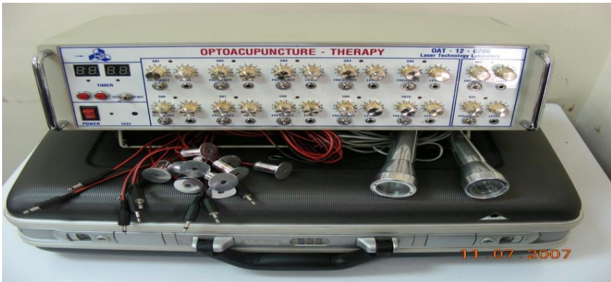
Hình 2.2 Thiết bị quang châm – quang trị liệu bằng laser bán dẫn công suất thấp loại 12 kênh.
