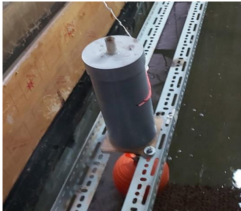
Hình 3.9 Máy phát điện tuyến tính sau khi chế tạo
