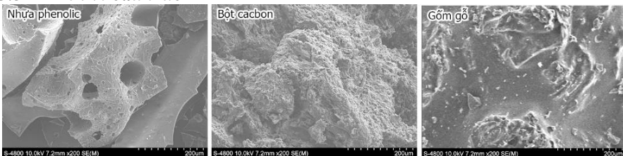
Hình 3.40: Ảnh vi cấu trúc các mẫu sau kết khối ở 900°C
