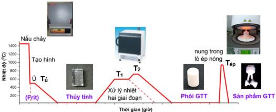
Hình 2-1 Quy trình gia công nhiệt và chế tạo mẫu GTT tạo hình ép nóng
