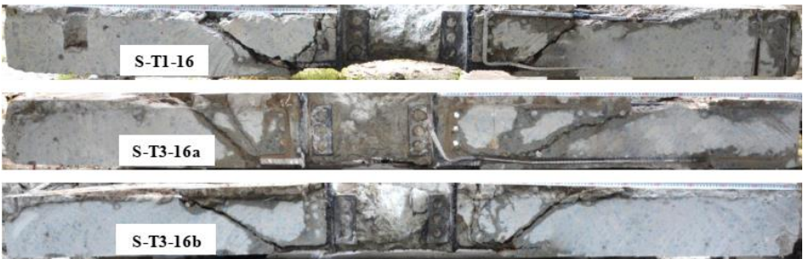
Hình 2.10. Hình dạng tháp chọc thủng của các mẫu liên kết sàn BTCT – cột CFT dùng chi tiết liên kết T1 và T3 theo mặt cắt ngang
