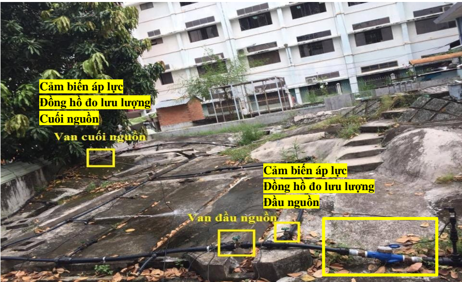
Hình 2.6 Mô hình thí nghiệm xác định áp suất âm do đóng van
